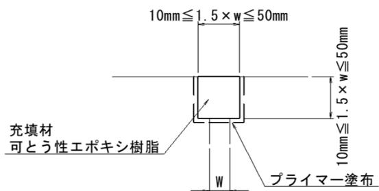
※ ひび割れ幅が15mmを超える場合、Uカット断面はひび割れ幅に応じて設定する(幅深さとも50mm以下とする)。
